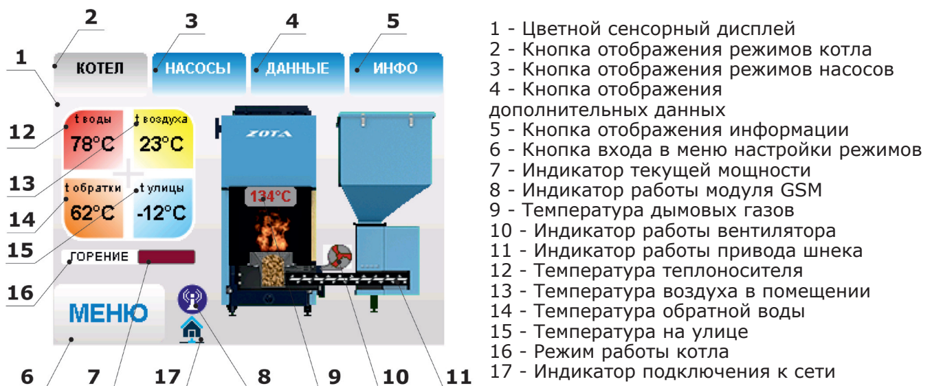
Рис.6 Расположение органов управления и индикации на передней панели пульта
